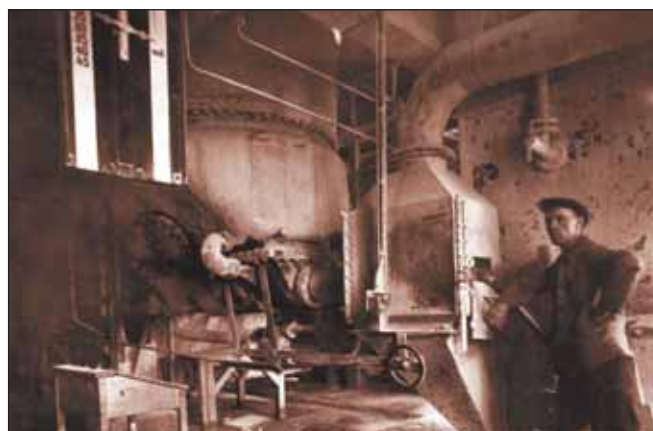
Ein Arbeiter am Trockenvergaser im Acetylenbetrieb, hier in einer Aufnahme aus dem Jahr 1948.
