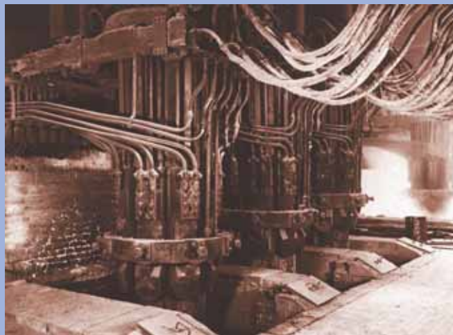
Die „dritte Stufe“ im Knapsacker Carbidofenbau: Nach Lonza-Öfen und Helfenstein-Öfen mit Paketelektroden hier ein Helfenstein-Ofen, der auf drei parallele Söderberg-Elektroden umgebaut worden war, wie ab 1921 alle Knapsacker Öfen dieser Bauart. Auf dieser Aufnahme ist einer der Öfen im ursprünglichen Carbidbetrieb beim Kraftwerk B I zu sehen. Er ist ausgeschaltet, während hinten rechts noch ein Ofen in Betrieb ist.
