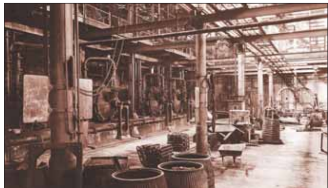
So sah es um 1930 im Essigsäurebetrieb aus. Essigsäure wurde dort aus Acetaldehyd hergestellt, der seinerseits die Stammlinie Carbid und Acetylen hatte. Aus Essigsäure wurde wiederum Essigsäureanhydrid gemacht.
