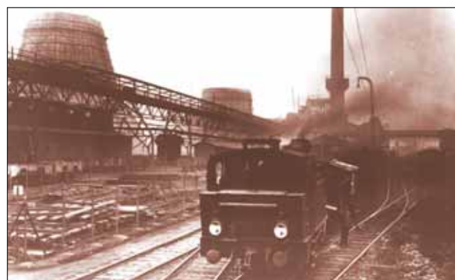
Eine Aufnahme vom Werksbahnhof. Die Dampflokomotive gehört zur Grubenanschlussbahn „Vereinigte Ville“ der Braunkohlenbergwerksgesellschaft Roddergrube. Das Chemiewerk war ein Unteranschließer von ihr und die Lokomotiven jener „Villebahn“ holten und brachten die Wagen für das Werk.
