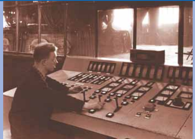
Mit der Einführung der geschlossenen Carbidöfen wurde die Arbeit für die Ofenbediener angenehmer. Hier ein Mitarbeiter am Steuerpult in der Messwarte (dem Regulierwerk) der beiden geschlossenen Öfen 10 und 20. Links hinter den Fenstern ist die Haube des Ofens 20 zu sehen. Aufnahme vom 5. April 1961.
