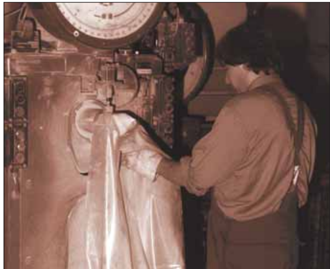
Bei der Abfüllung von „Hansa-Gelb“ im Azo-Pigmente-Betrieb, um 1984. Azo-Pigmente sind synthetische organische Farbkörper, die in Wasser schwer löslich sind. Sie werden in Ölfarben, Lacken, Druckfarben sowie zur Färbung von Kunststoffen und Papiermasse oder beim Pigmentdruck von Textilien verwendet.
