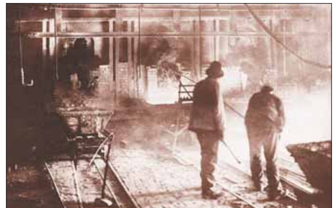
Carbidabstich an einem Helfenstein-Ofen. Nach den Öfen des Herstellers Lonza von 1908 waren sie die „zweite Ofengeneration“ in Knapsack.
